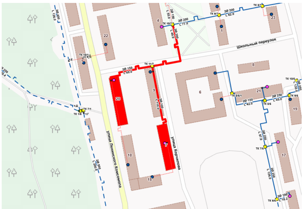
Рисунок 11.14.1 - Визуализация отключения запорной арматуры ТК10/7 – ТК10/8 (Котельная ЗАТО город Заозерск)
